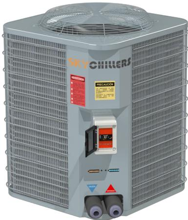
Las unidades enfriadoras de líquido SKCLA de SKYCHILLERS son del tipo integral con evaporador de placas, condensador enfriado por aire y compresor hermético.
